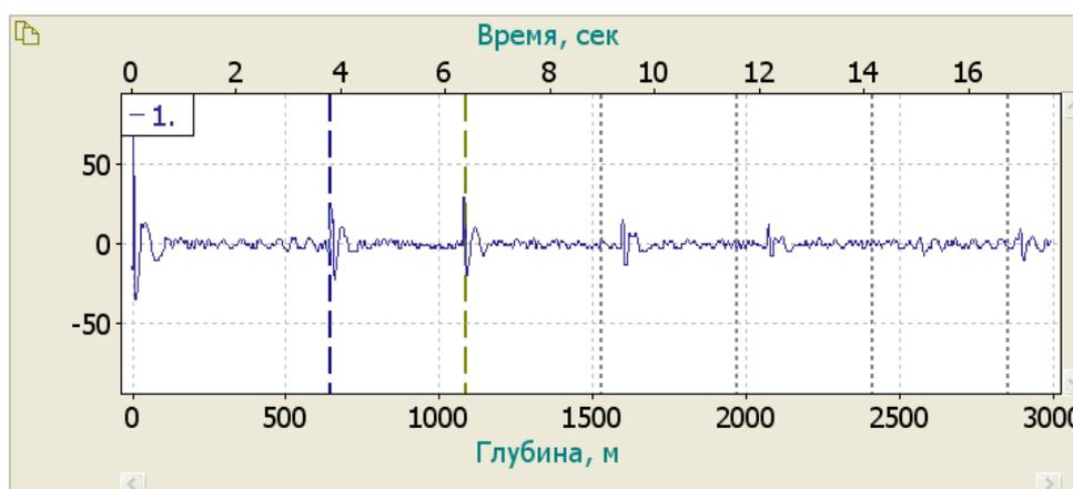
Панель 6: служит для указания, какую скорость звука использовать для определения уровня. Можно использовать одну из таблиц поправок (таблиц зависимости скорости звука в затрубном пространстве от давления в затрубном пространстве) или задать значение скорости звука непосредственно.
