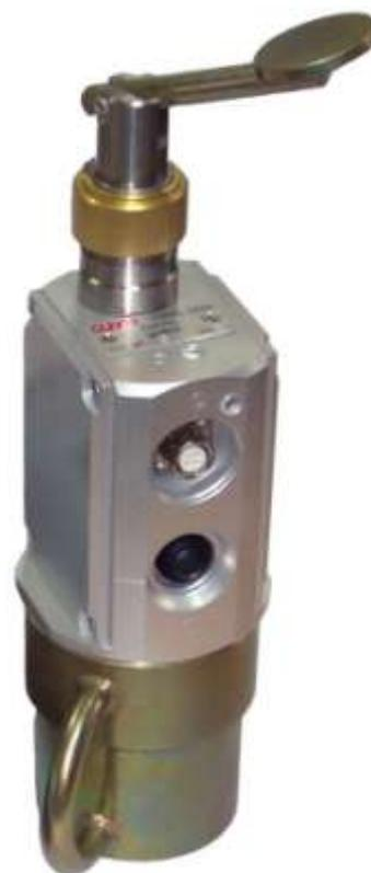
Для записи эхограммы датчик устанавливается на измерительный патрубок устьевого арматуры скважины и не требует использования соединительных кабелей. Выпускной клапан может вращаться без ограничения вокруг продольной оси для установки выкидного сопла в сторону от оператора.
